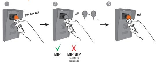
Repetir la opéración para cada tarjeta (10 tarjetas máxima se pueden añadir)
