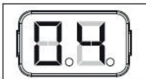
Durante el proceso de aprendizaje del sistema, el panel de control va a detectar automáticamente el consumo del motor que indica el nivel de resistencia de la puerta durante el funcionamiento del motor. Si éste aumenta inmediatamente o queda alto, comprobar que ningún objeto obstaculice en la zona de movimiento de la puerta y proceder a un control de su instalación.
