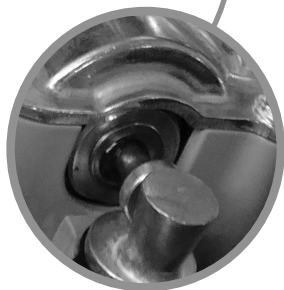
Posición del motor bloqueado : La espiga tiene que estar en posición salida
