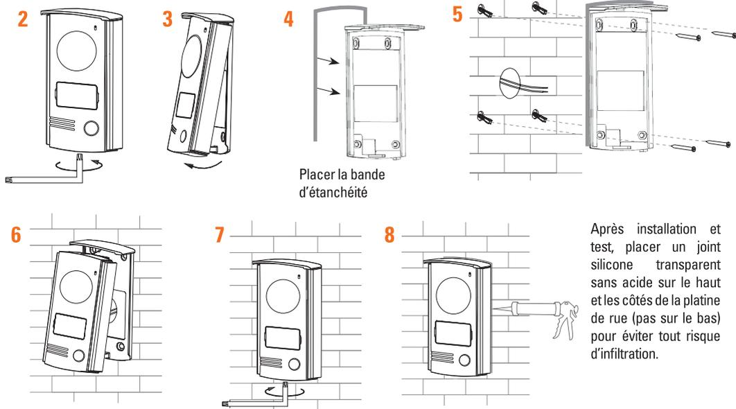
Après installation et test, placer un joint silicone transparent sans acide sur le haut et les côtés de la platine de rue (pas sur le bas) pour éviter tout risque d'infiltration.
