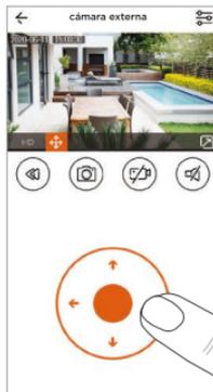
El joystick permite mover la vista de la cámara de arriba abajo y de izquierda a derecha.
