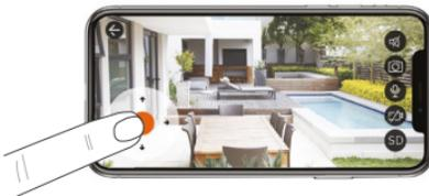
Un angle de vue de 75° et un angle de rotation de 300° permettent d'atteindre un champ de vision de 360°. Pour cela il suffit de faire tourner la caméra à l'aide des flèches depuis l'application.
