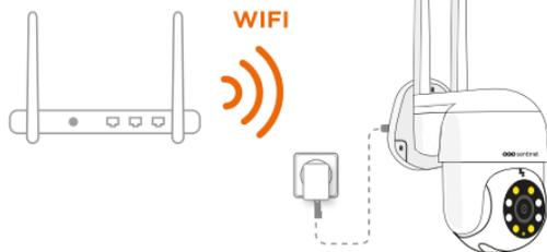
Branchez l'alimentation de la caméra et placez la à proximité de votre routeur Wi-Fi. Votre téléphone doit être connecté au même réseau Wi-Fi que votre caméra et la localisation doit être activée. Attendez le signal sonore.
