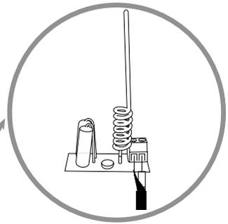
Para mejorar el alcance de sus controles remotos, se puede conectar la antena situada en la luz intermitente con un cable coaxial tipo RG58 (no suministrado). En este caso, hay que desconectar la antena de origen. Conectar el latón central del cable coaxial sobre la borna «ANT» y la trenza sobre la borna « GND», de cada lado (antena y tarjeta).
