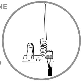
Si vous souhaitez améliorer la portée de vos télécommandes, vous pouvez brancher l'antenne située dans le feu clignotant avec un câble coaxial type RG58 (non fourni). Dans ce cas, vous devez déconnecter l'antenne d'origine. Branchez le cuivre central du câble coaxial sur la borne «ANT» et la tresse sur la borne «GND», côté antenne et côté carte électronique.
