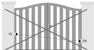
Alignment / Aligning / Allineamento / Alineación / Alinhamento
