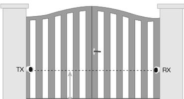
Alignment / Aligning / Allineamento / Alineación / Alinhamento
