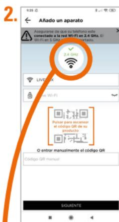
Introducir la clave Wi-Fi, escanear el código QR de la parte trasera del monitor o introducir el código manualmente.
