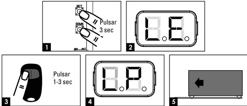
(2) Para restablecer los parámetros de fábrica, pulsar y mantener las teclas « UP » y « DOWN » hasta que la pantalla muestre «CL».
