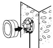
Después del cableado de sus fotocélulas, modificar el programa H y ajustarlo en H-1 para que sus fotocélulas se activen. Si no, no tendrán ningún efecto sobre el funcionamiento de su automatismo.
