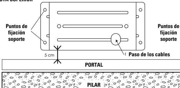
Perforar la base de soporte de hormigón e instalar los 4 tornillos metálicos o químicos para fijar su placa de soporte motor. Pasar todos los cables de alimentación y de accesorios. Asegurarse, con ayuda de un nivel a burbuja de que la placa de fijación del motor esté bien nivelado. Posicionar el motor y fijarlo con los dos tornillos incluidos.
