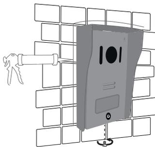
Μετά την τοποθέτηση & δοκιμή του συστήματος, τοποθετήστε διαφανή σιλικόνη στο πάνω μέρος και στα πλαϊνά της μπουτονιέρας. Όχι στο κάτω μέρος!
