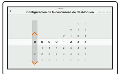
Ajustar el código deslizando los dígitos de arriba hacia abajo (de 1 a 8 dígitos) empezando por la derecha. (ej. el código registrado es 1234).
