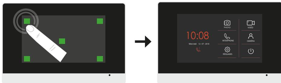
Au démarrage, appuyer sur les 5 cibles vertes apparaissant les unes après les autres aux 4 coins de l'écran et au centre. Patientez jusqu'à ce que l'écran d'accueil apparaisse.
