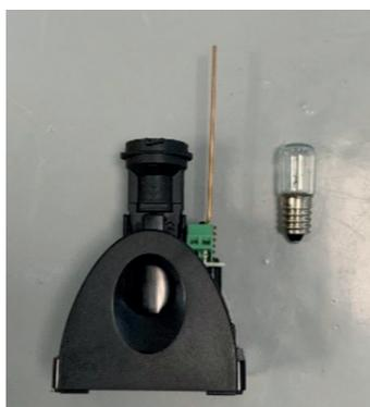
Dévisser l'ampoule dans le sens inverse des aiguilles d'une montre.
