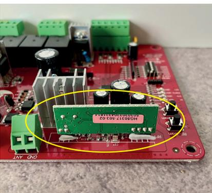
**Réinsérer le nouveau récepteur et n'oubliez pas de rebrancher le transformateur. Attention au positionnement des broches (4 d'un côté et 2 de l'autre)**
