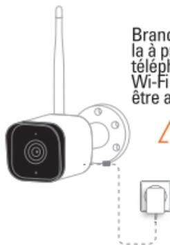
Branchez l'alimentation de la caméra et placez-la à proximité de votre routeur Wi-Fi. Votre téléphone doit être connecté au même réseau Wi-Fi que votre caméra et la localisation doit être activée. Attendez le signal sonore.
