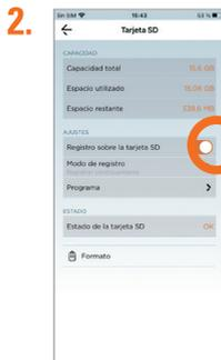
2. Pulsar «Registro sobre la tarjeta SD» para guardar automáticamente las fotografías y los videos en la tarjeta micro SD del monitor.
