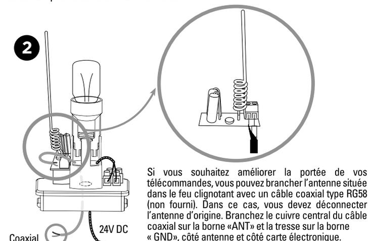
Si vous souhaitez améliorer la portée de vos télécommandes, vous pouvez brancher l'antenne située dans le feu clignotant avec un câble coaxial type RG58 (non fourni). Dans ce cas, vous devez déconnecter l'antenne d'origine. Branchez le cuivre central du câble coaxial sur la borne «ANT» et la tresse sur la borne «GND», côté antenne et côté carte électronique.
