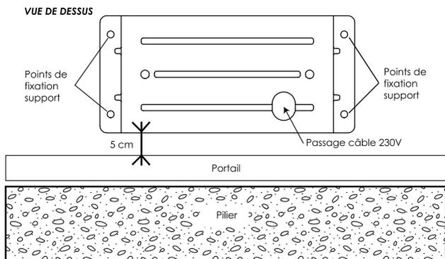
Percez votre support béton et installez vos 4 chevilles métalliques ou à scellement chimique pour fixer votre plaque de support moteur. Passez tous les câbles d'alimentation et d'accessoires. Assurez-vous à l'aide d'un niveau à bulle que la plaque de fixation du moteur soit bien de niveau. Positionnez votre moteur et boulonnez le avec les deux vis fournies.
