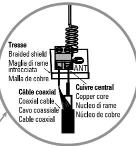
Si vous souhaitez améliorer la portée de vos télécommandes, vous pouvez brancher l'antenne située dans le feu clignotant avec un câble coaxial type RG58 (non fourni). Dans ce cas, vous devez déconnecter l'antenne d'origine. Branchez le cuivre central du câble coaxial sur la borne «ANT» et la tresse sur la borne «GND», côté antenne et côté carte électronique.
