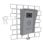
Después la instalación y prueba, colocar un junta de silicone transparente sin ácido arriba y sobre los lados de la placa exterior (no abajo) para evitar los riesgos de infiltración.
