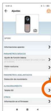
Pulse «Tarjeta micro SD» para acceder a los ajustes.
