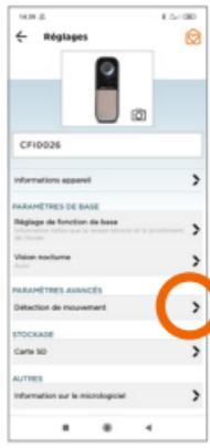
Appuyez sur «Sensibilité» pour gérer le détecteur de mouvement. Plus la sensibilité est haute, plus la caméra détecte un mouvement.
