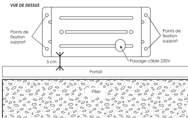
Percez votre support béton et installez vos 4 chevilles métalliques ou à scellement chimique pour fixer votre plaque de support moteur. Passez tous les câbles d'alimentation et d'accessoires. Assurez-vous à l'aide d'un niveau à bulle que la plaque de fixation du moteur soit bien de niveau. Positionnez votre moteur et boulonnez le avec les deux vis fournies.
