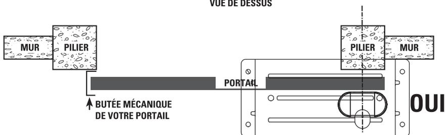
Le bord de la plaque de fixation doit se trouver à 5 cm du bord du portail.
