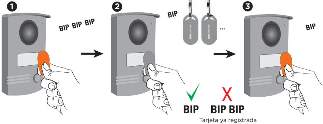
Repetir la operación para cada tarjeta (10 tarjetas máxima se pueden añadir)
