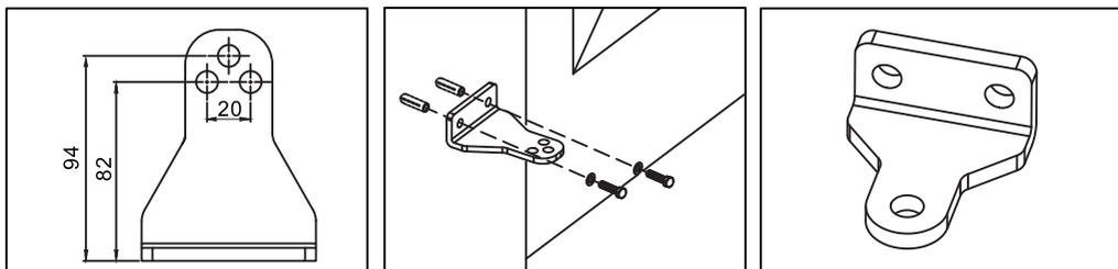
Colocar el automatismo en el soporte, poner el pasador según los planes de montaje no.1 y no.2
