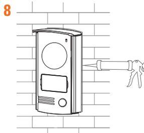
Después la instalación y prueba, colocar un junta de silicone transparente sin ácido arriba y sobre los lados de la placa exterior (no abajo) para evitar los riesgos de infiltración.
