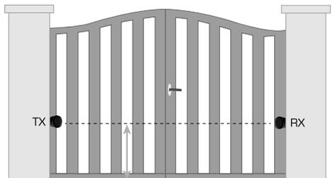
Alignement / Aligning / Allineamento / Alineación
