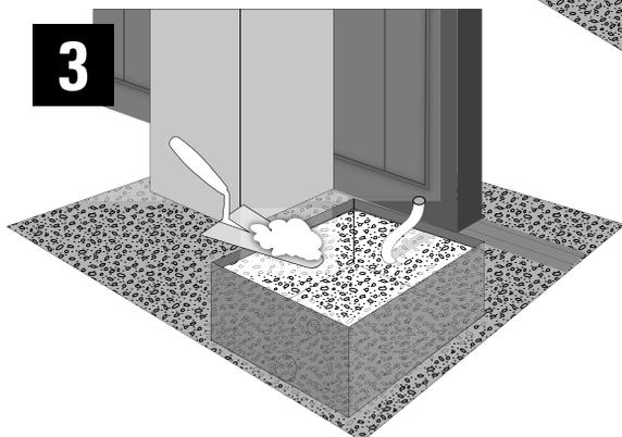
Percez votre support béton et installez vos 4 chevilles métalliques ou à scellement chimique pour fixer votre plaque de support moteur. Passez tous les câbles d'alimentation et d'accessoires. Assurez-vous à l'aide d'un niveau à bulle que la plaque de fixation du moteur soit bien de niveau. Positionnez votre moteur et boulonnez le avec les deux vis fournies.
