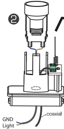
Si vous souhaitez améliorer la portée de vos télécommandes, vous pouvez brancher l'antenne située dans le feu clignotant avec un câble coaxial type RG58 (non fourni). Dans ce cas, vous devez déconnecter l'antenne d'origine. Branchez le cuivre central du câble coaxial sur la borne «ANT» et la tresse sur la borne «GND», côté antenne et côté carte électronique.
