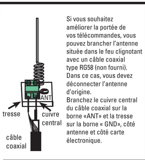
Si vous souhaitez améliorer la portée de vos télécommandes, vous pouvez brancher l'antenne située dans le feu clignotant avec un câble coaxial type RG58 (non fourni). Dans ce cas, vous devez déconnecter l'antenne d'origine. Branchez le cuivre central du câble coaxial sur la borne «ANT» et la tresse sur la borne «GND», côté antenne et côté carte électronique.
