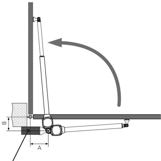
pièce nécessaire pour adapter l'équerre de fixation au pilier (non fournie)
