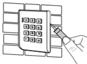
Pour une meilleure étanchéité, siliconez le dessus et les 2 côtés du clavier.
