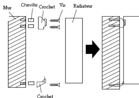
**Attention :** Avant la mise en marche de l'appareil assurez-vous que le radiateur soit correctement fixé au mur. Si le radiateur n'est pas de niveau, des problèmes peuvent survenir.
